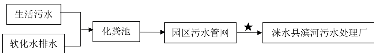
图 3-1 厂内污水处理流程及监测点位图 ★：废水监测点位
